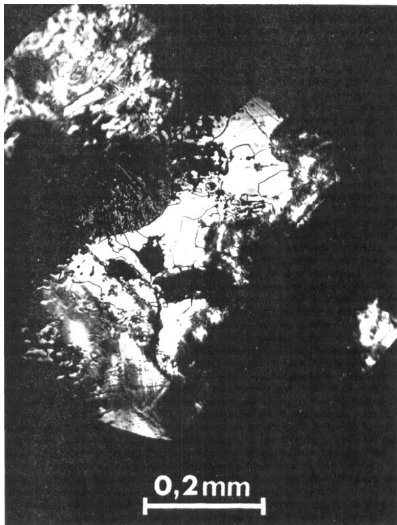
Figure 6. Photomicrographie d'une lame de pp' azoxyanisole dans une amorce de clivage (100) d'un cristal de chlorure de potassium. Les plages parallèles sont à l'extinction entre polariseurs rectilignes croisés. ↗ Les plages hélicoïdales ne sont pas éteintes.
